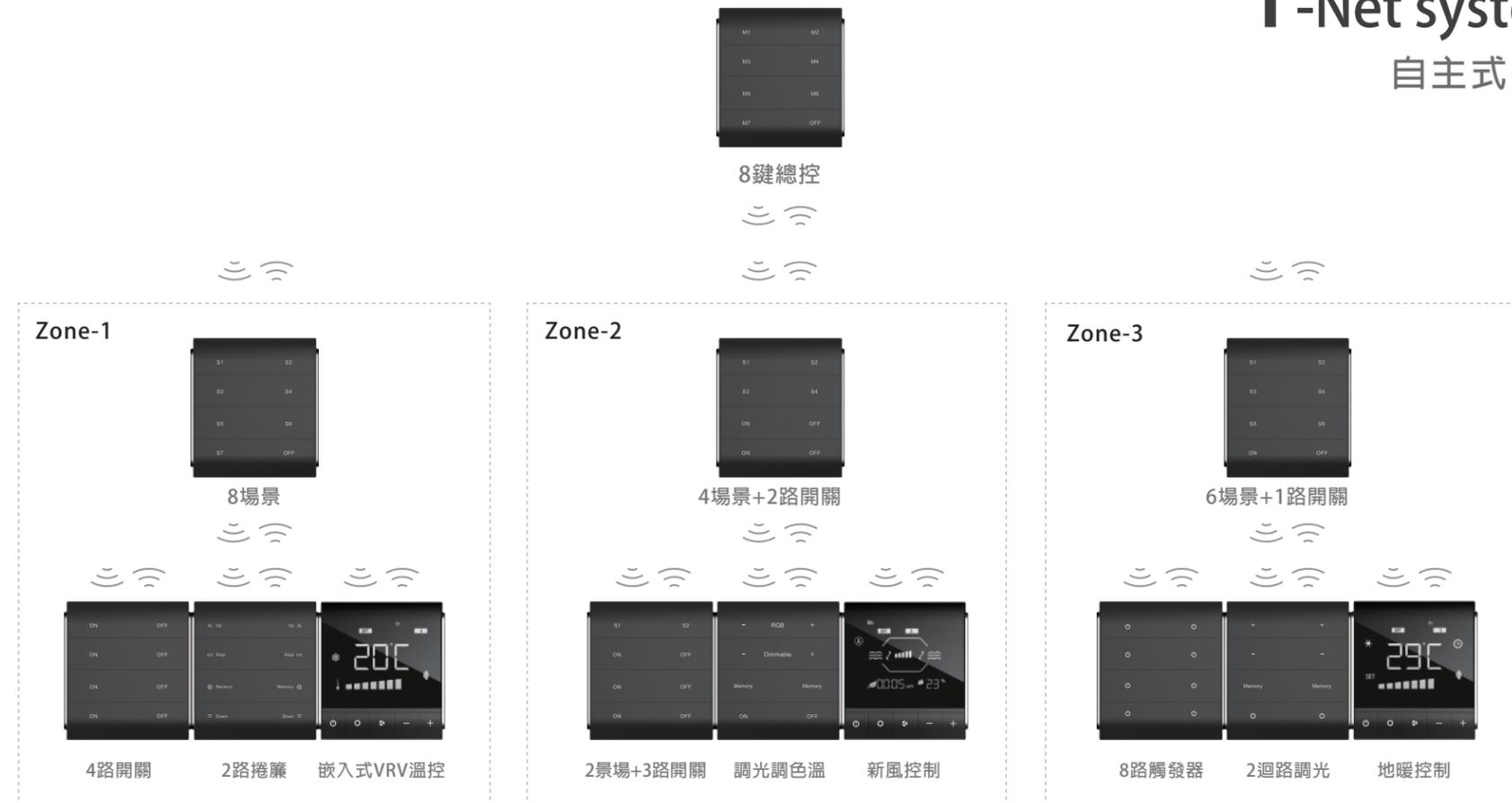
**總**控面板內置主處理器，可管理組合各區域場景面板，或組合全系統中的功能面板的各項狀態，靈活應用總控的組合。當脫離系統亦不影響各區域的傳輸功能。
